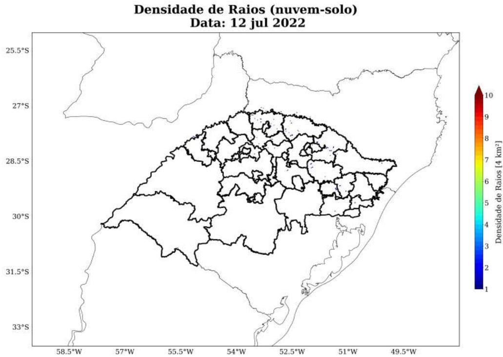
Figura 6: Densidade de descargas atmosféricas nuvem-solo detectadas pelo sistema Earth Networks para o período 11 a 12 de julho de 2022 sobre a área de concessão da RGE-RS.
